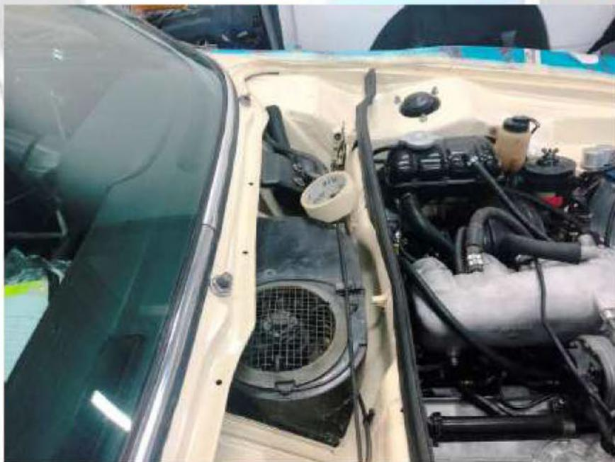
*Les différentes durites de carburant et de refroidissement moteur ont été remplacées. Nous relevons des dates de fabrications de 2016 sur ces éléments.*
