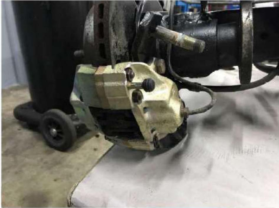
*Pont Arrière démonté et contrôle du serrage du différentiel + remplacement joints.*
